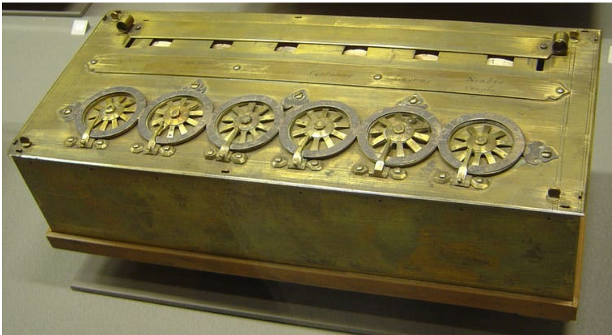
Une pascaline, signée par Pascal en 1652, au musée des arts et métiers du Conservatoire national des arts et métiers à Paris. David.Monniaux/Wikimedia , CC BY
